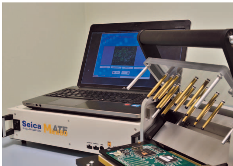
Fig. 3 - Sistema composto da Mini80, PC e tastatore
